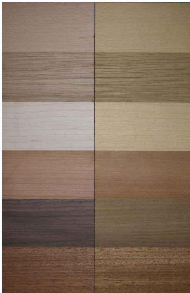
Ilustracja: Naświetlone drewno surowe. Od góry: buk, dąb, klon, wiśnia, orzech, mahoń. Prawa połowa jest naświetlona (test słoneczny Atlas).
