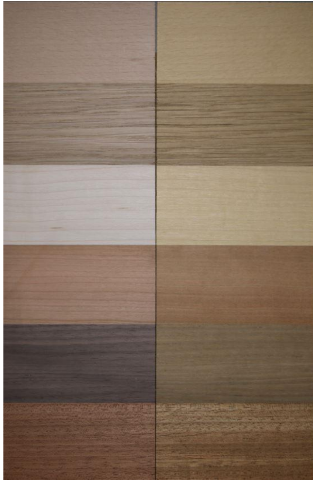
Abbildung: belichtete Rohhölzer. Von oben nach unten: Buche, Eiche, Ahorn, Kirschbaum, Nussbaum, Mahagoni. Die rechte Hälfte ist belichtet (Atlas-Suntest).
