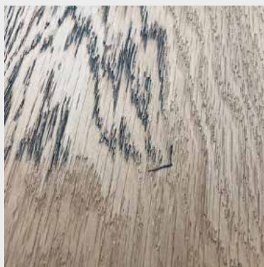
Afbeelding 1: visuele weergave van verkleuring van openporig hout door vocht (zichtbaar gemaakt met een ijzeroplossing).
