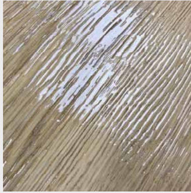
Afbeelding 3: Openporig hout na de eerste stap van de PORE-GUARD-procedure.
