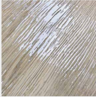
Abbildung 3: Offenporiges Holz nach dem 1. Schritt des POREGUARD-Verfahrens.
