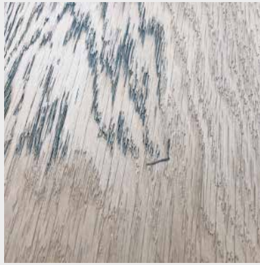
Abbildung 1: Visualisierung der Verfärbung von offenporigem Holz unter dem Einfluss von Feuchtigkeit (sichtbar gemacht mit einer Eisenlösung).
