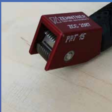
Siatka nacięć (wg DIN EN ISO 2409): badanie przyczepności
