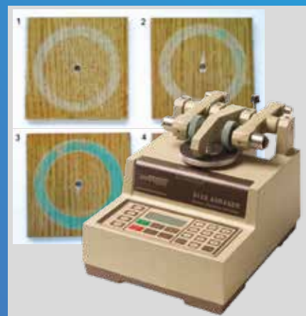
Test „Taber”: określenie odporności na ścieranie wg różnych norm
