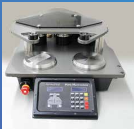
Mikrozadrapania wg EN 16094 dla zastosowań: posadzki z okładzin i paneli podłogowych, laminaty wysokociśnieniowe, wysokopółtyskowe lub polerowane powierzchnie
