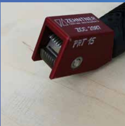
Gitterschnitt (volgens DIN EN ISO 2409): Hechtingstest
