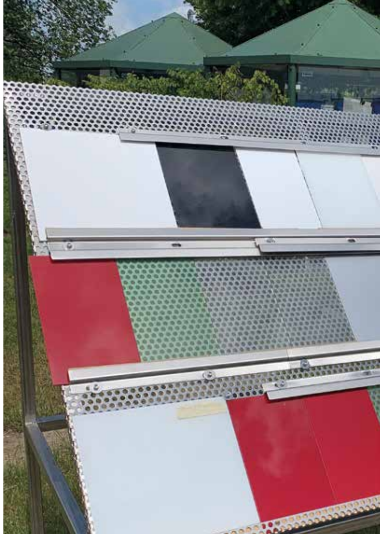
Buitenverwerking van glaslakoppervlakken
