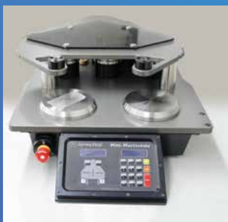
Résistance aux micro-rayures conformément à la norme EN 16094 pour : les revêtements de sol stratifiés, les revêtements de sol, les stratifiés haute pression, les surfaces hautement brillantes ou polies
