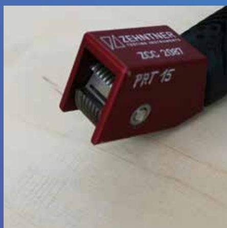
Uadrillage (selon la norme DIN EN ISO 2409) : contrôle de l'accrochage
