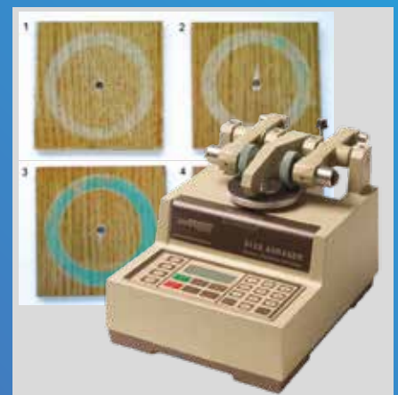
Taber Test: Ermittlung der Abriebbeständigkeit nach verschiedenen Normen
