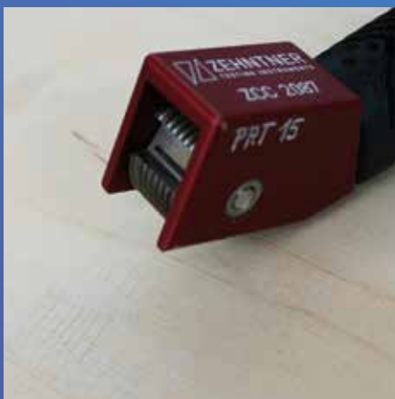
Gitterschnitt (nach DIN EN ISO 2409): Prüfung des Verbundes
