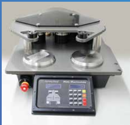
Mikroverkatzung gemäß EN 16094 Anwendungen: Laminat-, Bodenbeläge, Hochdruck-Lamine, hochglänzende oder polierte Oberflächen
