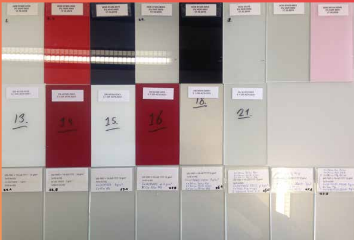
QUV Testflächen (*) zur Prüfung der Beständigkeit gegen UV Strahlung des Sonnenlichts
